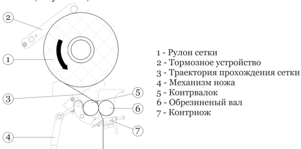
Рисунок 7.9 Схема заправки сетки
